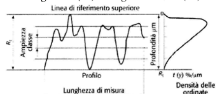
2 Fig. 2: Total roughness (Rt) ~ Rugosità totale (Rt)
